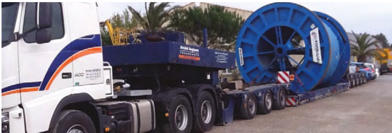
Figure 9 : Touret de câbles
