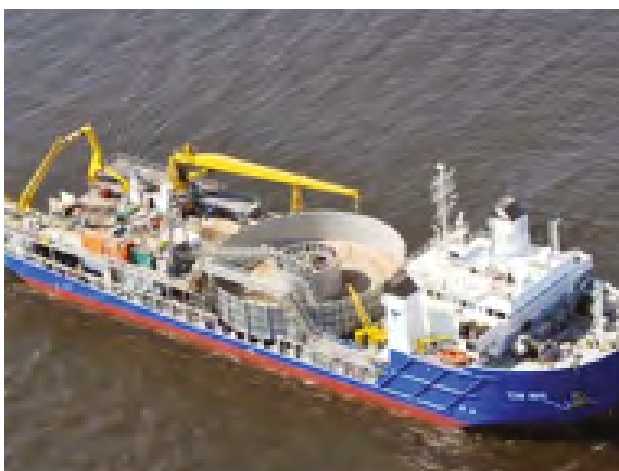
Figure 12 : Exemples d'engin de pose et de navire câblé
