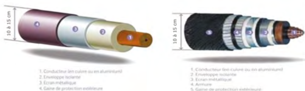
Figure 6 : Coupes des câbles souterrains et sous-marins
